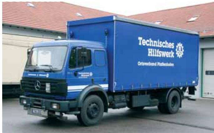
Der LKW der Fachgruppe WP vor und nach dem Umbau der Pritsche. Der Aufbau wurde um rund 30 Zentimeter erhöht, außerdem Seitenschiebeplänen eingebaut. Die Ausstattung wird erst bei Bedarf verladen, somit steht der Mercedes auch als normale Transportkomponente zur Verfügung. Das Fahrzeug besitzt eine Zulassung für Gefahrguttransporte, daher ist die Auspuffanlage vorne unterhalb der Stoßstange montiert.
