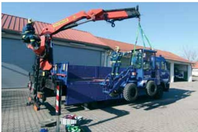
Bei Bedarf wird der 1,9 Tonnen schwere Radlader zum Einsatzort mitgenommen. Die Verladung auf den Kipper übernimmt der Ladekran. Zuvor muss die Kranverlängerung demontiert werden.
