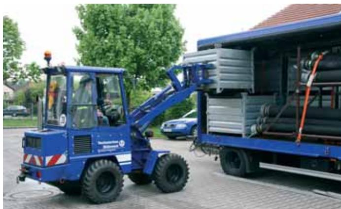
Der zwillingsbereifte Anhänger lässt sich mittels Schiebepläne und Ladebordwand von drei Seiten beladen. Die Pumpenausstattung ist in Vollwandboxen verlastet, der Radlader ist beim Handling hilfreich. Zuvor hatte man in Pfaffenhofen Gitterboxen verwendet, die sich jedoch nicht bewährten. Für den Betrieb der Ladebühne sind eine Batterie sowie ein Stromerzeuger eingebaut.
