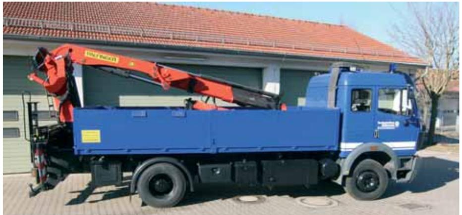
Der LKW-Kipper ist mit einem heckseitig montierten Palfinger-Ladekran ausgerüstet. Er hat eine Ausladung von 8,2 Metern und kann damit bis zu 1600 kg heben.
