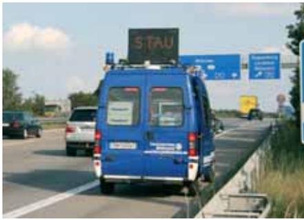
Der Mannschaftstransportwagen (MTW) des Technischen Zuges wird gleichzeitig für Autobahndienste verwendet. Die digitale Anzeigetafel auf dem Dach wird im Juni 2009 nachgerüstet, es können verschiedene Warnmeldungen geschaltet werden.
